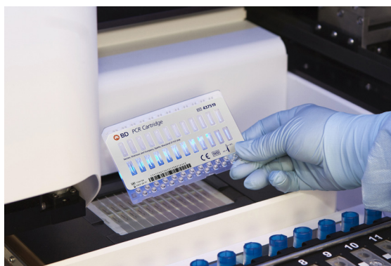
Рис. 2. Загрузка картриджей для ПЦР BD PCR Cartridge
